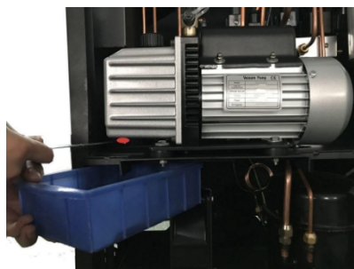
Skru olieaftapningsskruen ud for at aftappe brugt vakuumpumpeolie
