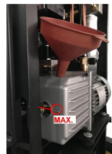
Fyld ny olie på til korrekt niveau
