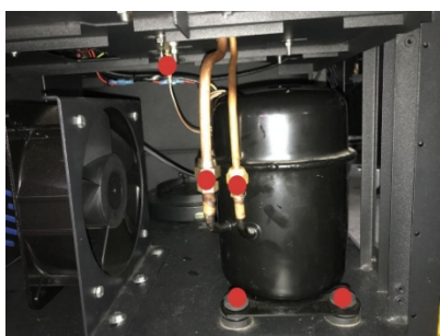
Fjern rør og skruer
